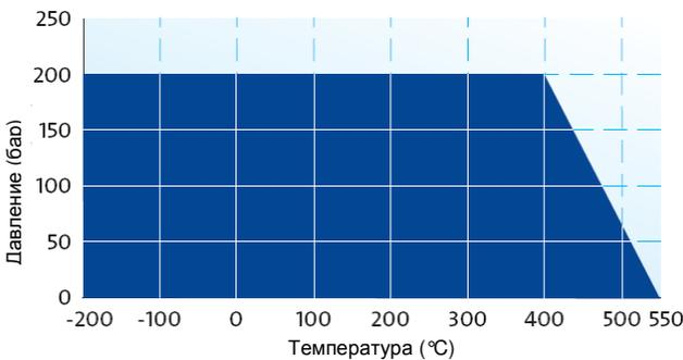
Рекомендуемые температуры и давления, указанные в таблице, определены для использования прокладок толщиной в 2 мм и гладких фланцев. При применении тонких прокладок могут быть достигнуты более высокие параметры.
